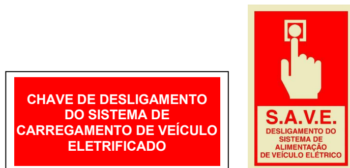
Figura 1 – Sinalização da Chave de Desligamento
