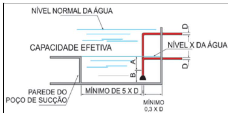
Figura B-1 – Tomada superior de sucção para bomba fixa
