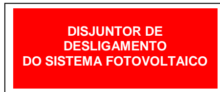
Figura 2 – Sinalização do Disjuntor de Desligamento para Sistemas Tipo 2
