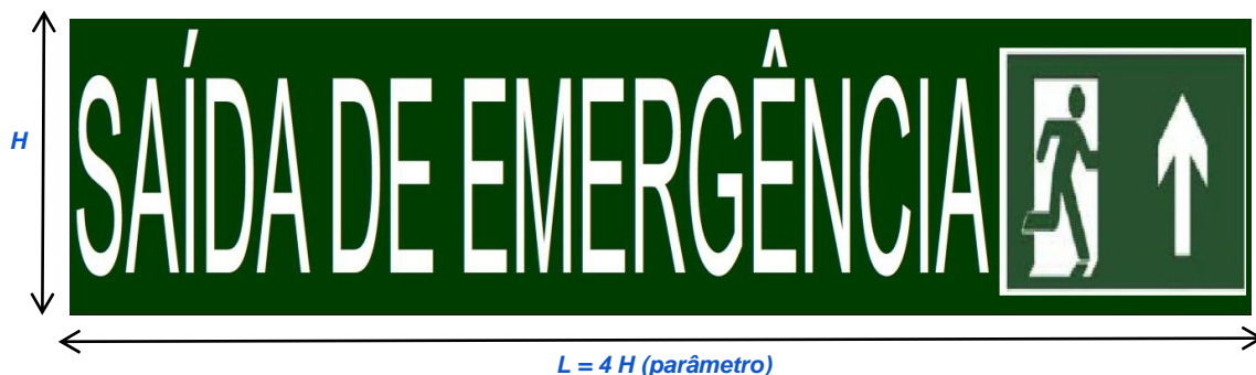
Figura 1 do Anexo B – Exemplo de faixa de sinalização de emergência com fundo verde e letras brancas
