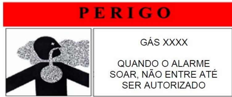
Figura 2 – Sinalização de advertência externa aos ambientes protegidos
