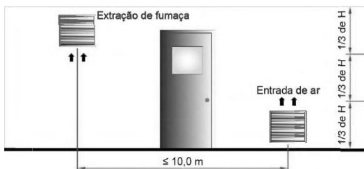
Figura 20 – Posição de aberturas de extração e introdução de ar
