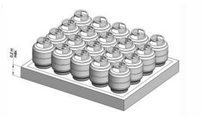
Figura 3 – Exemplo de Área de Armazenamento com Piso Elevado sem Corredor de Circulação
