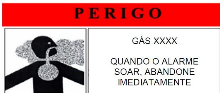
Figura 1 – Sinalização de advertência para interior dos ambientes protegidos
