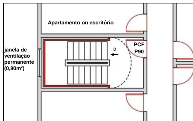
Figura 7 – Escada enclausurada protegida
