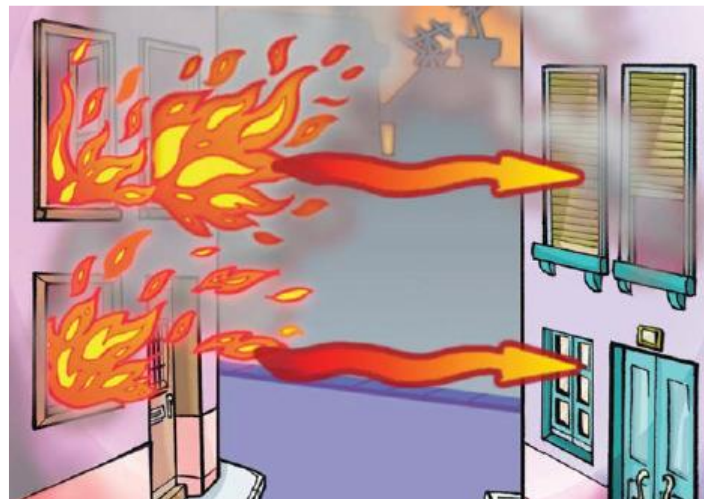
Figura 8 – Radiação de calor de um edifício para outro (Fonte: Escola Nacional de Bombeiros, Fenomenologia da Combustão e extintores, Volume VII)
