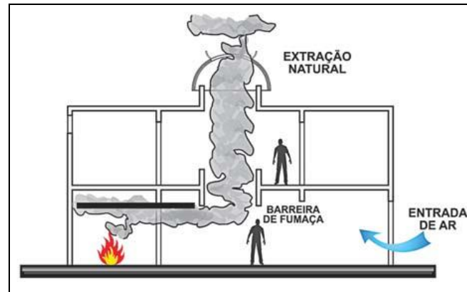
Figura 12 – Extração de fumaça de áticos
