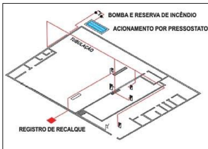
Figura 41 – Isométrica de sistema de hidrantes
