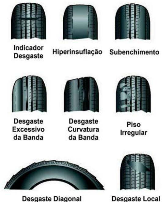
Figura 14 – Tipos de desgaste em pneus
