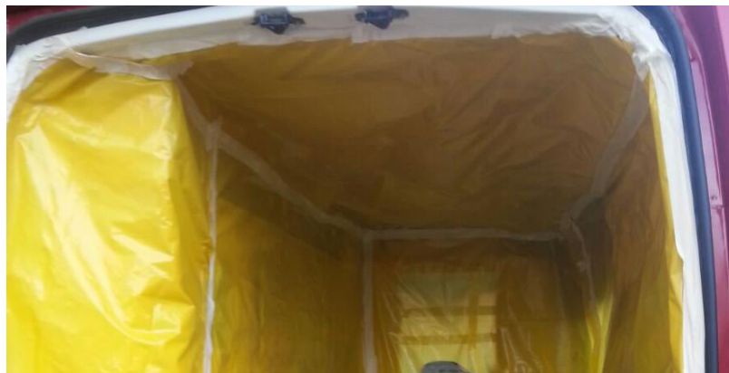
Foto 2 – Utilização da fita adesiva para fixar as partes da lona Fonte: TC QOC Jonas
