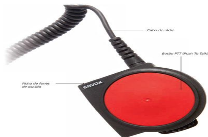
Imagem 3 — Push to Talk , botão grande sensível ao toque, composto por: cabo do rádio, botão PPT e ficha de fone de ouvido.
