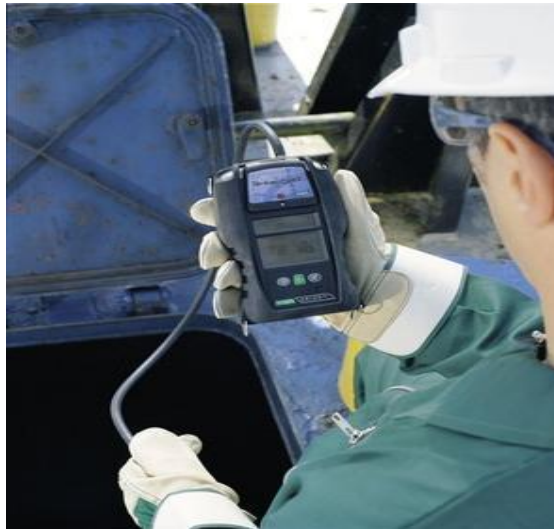
Figura 10 - Verificando Nível de Gás na Atmosfera Fonte: internet
