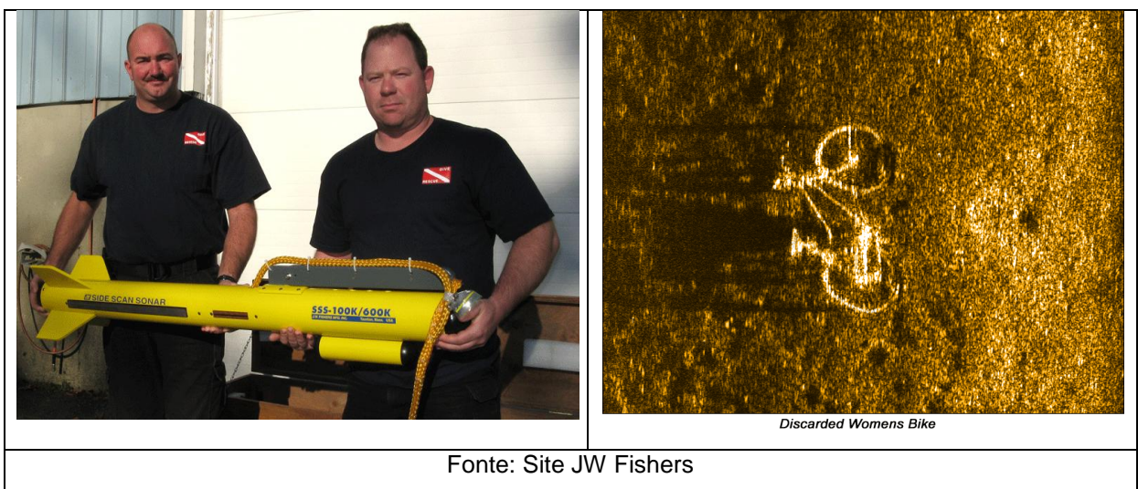
Figuras 16, 17, 18 e 19 – Mostrando o SVL JW Fisher SSS-600K e seus resultados ou imageamentos:
