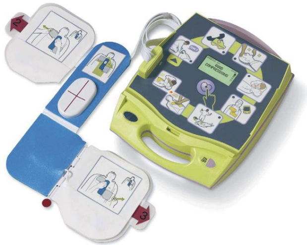
Figura 3 – Modelo de desfibrilador externo semiautomático
