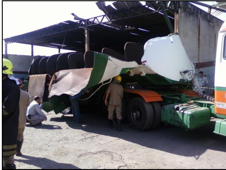
Figura 1 - Atendimento a ocorrência de explosão de carreta-tanque em agosto de 2010 em Goiânia-GO (Fonte: Cap QOC Valério através de guarnições do CBMGO).
