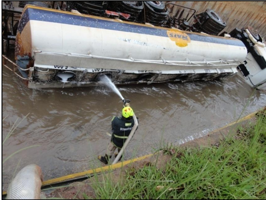
Figura 7 - Processo de Desvaporização em ocorrência na marginal botafogo atendida pelo CBMGO (Fonte: Cap QOC Valério através de guarnições do CBM-GO).
