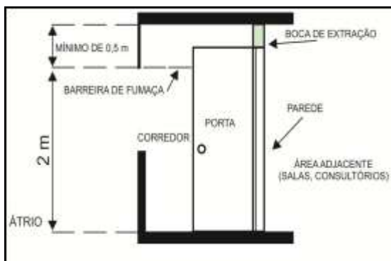
Figura 36 – Exemplo de locais fechados com acesso à circulação por meio de uma porta
