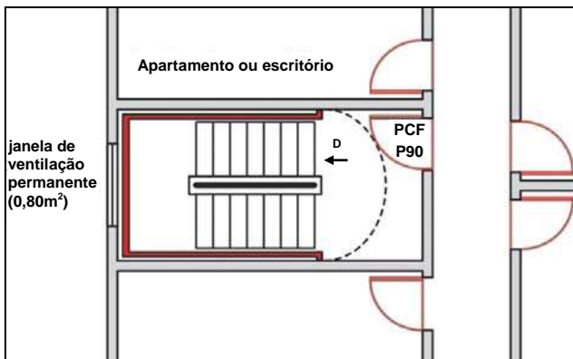
Figura 7 – Escada enclausurada protegida
