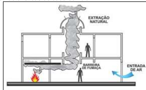
Figura 11 – Extração de fumaça de átrios
