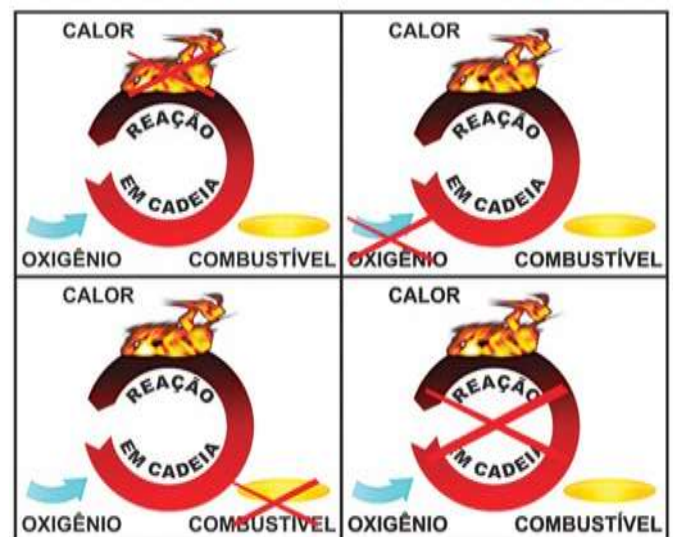
Figura 2 – Mecanismo de extinção do fogo
