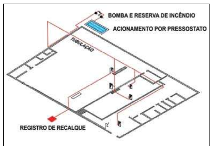
Figura 42 – Isométrica de sistema de hidrantes
