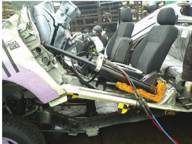
Figura 6.37. Rebatimento de painel
