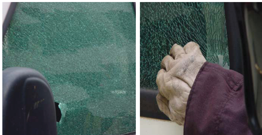
Figura 6.17. Entrada forçada em vidro temperado
