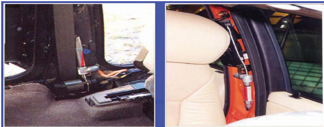
Figura 6.24. Cilindro de gás do pré-tensionador de cinto
