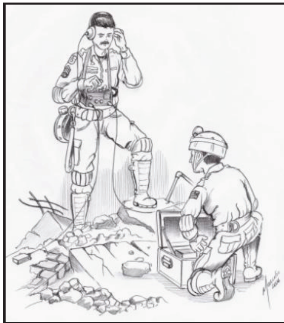
Figura 12.7.3.2.a - Equipe utilizando geofone
