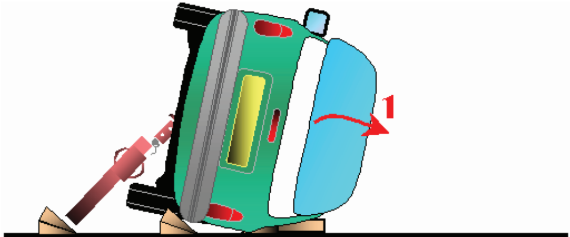
Figura 6.52. Retirada do vidro traseiro
