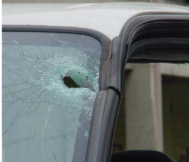
Figura 6.18. Furo em vidro laminado para entrada da serra-sabre
