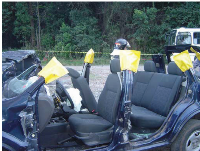
Figura 6.6. Sacolas de proteção de ferragens
