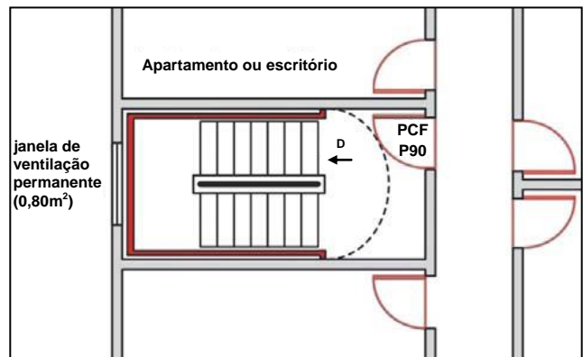
Figura 7 – Escada enclausurada protegida
