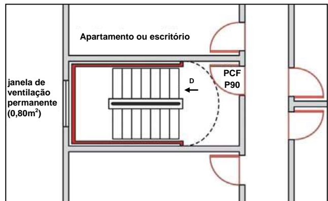
Figura 7 – Escada enclausurada protegida
