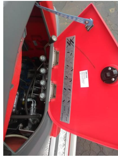
Foto 8 – Alavancas de comando da escada Fonte: Do autor
