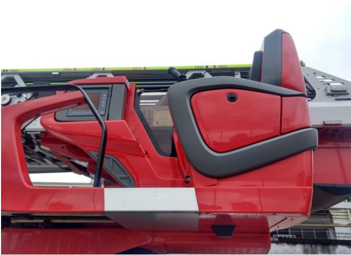
Foto 7 – Central de comando Principal (lateral) Fonte: Do autor
