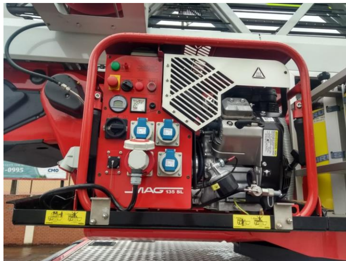
Foto 04 – Gerador ligado à parte elétrica da Auto Escada Fonte: Do Autor
